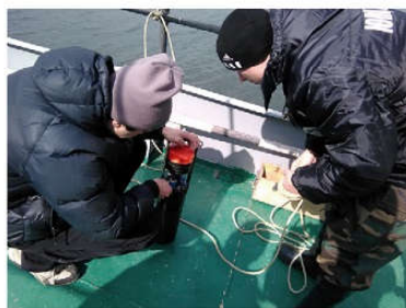
Настройка регистратора течений термосолемера
